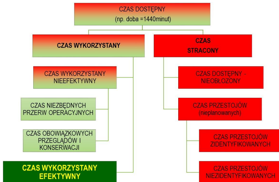
Rys. 3. Czas wykorzystany a czas dostępny kompleksowo zmechanizowanej ściany wydobywczej [4]
