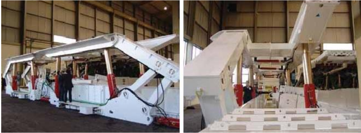
Rys. 10. Przykład zmechanizowanej obudowy chodnikowej chodnika podścianowego dla dwu-przeñośnikowej ściany podbierkowej [12]
